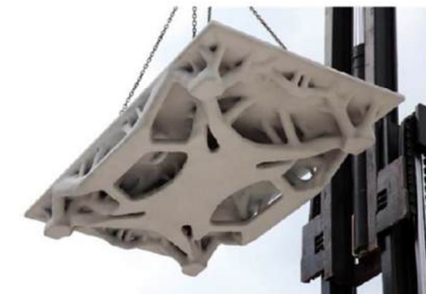
Abb. 6. Anwendungsbeispiele für das Partikelbett-3D-Drucken: Fassadenelemente, Brücken, Pavillons, Decken- und Knotenelemente [Fle2024] [add2024] [AMC2023] [Rae 2018] [Jip2016] [Low2022].
