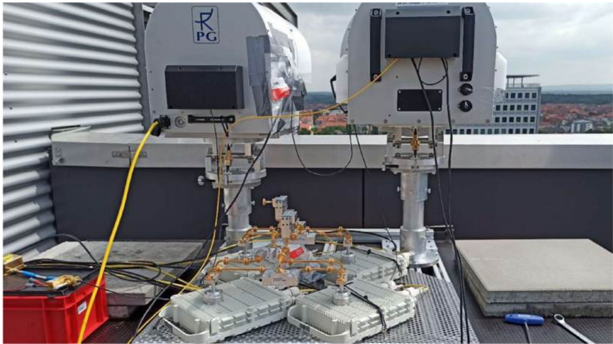
Abb. 2. Komponenten einer THz-Punkt-zu-Punkt-Funkstrecke in Braunschweig.
