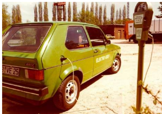
Abb. 4. VW Golf I CityStromer 1976. Diese Elektro-Variante diente zu Testzwecken und wurde in 20 Ausfertigungen von RWE genutzt. (Quelle: "obs/Volkswagen")
